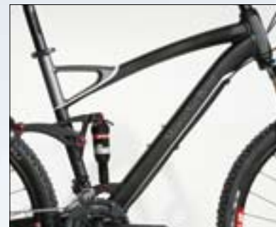
Двухподвес. Материал: Aluminium 7005, скругленная форма, эксклюзивный дизайн «Мерседес-Бенц».
