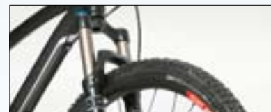
Передняя вилка с амортизацией Fox Racing F32 RL, функция блокировки, ход – 120 мм.
