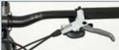
Тормозная система Avid Elixir 5-дисковый тормоз, диаметр диска – 185 мм.
