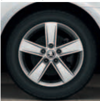
Легкосплавный колесный диск 6.0J x 16" Star для шины 205/55 R16 серебристый цвет (5E0 071 494A 8Z8); Совместим с зимними цепями
