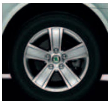
Легкосплавный колесный диск Pyxis (1Z0 071 492A); 6.5J x 15"; шины 205/60 R15; зимние цепи (CER 300 002A); возможно применение с шинами 195/65 R15
