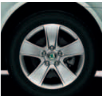
Легкосплавный колесный диск Crateris (120 071 494); 6.5J x 16"; шины 205/55 R16
