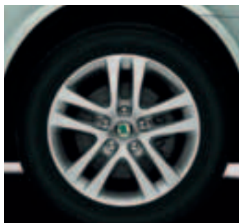
Легкосплавный колесный диск Draconis (120 071 494А); 6.5J x 16"; шины 205/55 R16
