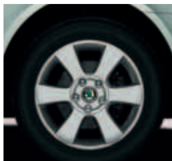
Легкосплавный колесный диск Lyra (CCA 600 005); 6.5J x 16"; шины 205/55 R16
