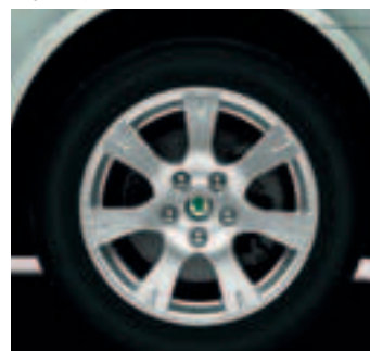
Легкосплавный колесный диск Sirius (CCB 600 006); 6.5J x 16"; шины 205/55 R16
