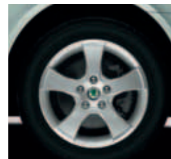
Легкосплавный колесный диск Apollon (CCH 600 007); 6.5J x 16"; шины 205/55 R16
