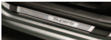
Декоративные накладки на пороги со стальными вставками передние и задние (KDA 800 002)
