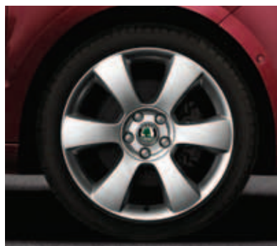
Легкосплавный колесный диск 7.5J x 18" Luna шины 225/40 R18 (CCA 800 001)
