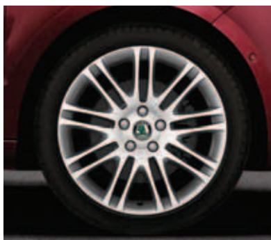
Легкосплавный колесный диск 7.5J x 18" Luxon шины 225/40 R18 (CCX 800 004); в антрацитовом сером дизайне (CCX 800 004A)
