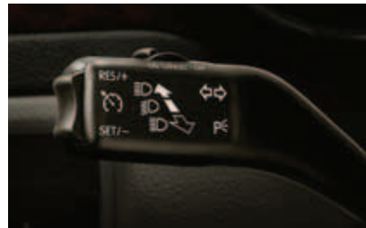
Устройство регулирования скорости (круиз-контроль) для всех версий двигателей для автомобилей с встроенным бортовым компьютером (3T0 035 623); для автомобилей без встроенного бортового компьютера (3T0 035 623A)
