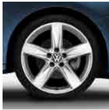
Volkswagen Original Легкосплавный диск Toras Размер диска: 7,5 J x 18", вылет 51 Используемый размер шин: например, 225/40 R18 Цвет: серебристый Sterling Арт. 5K0 071 498 88Z Возможен заказ колеса в сборе.
