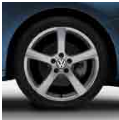
Volkswagen Original Легкосплавный диск Goal Размер диска: 7,5 J x 17", вылет 50 Используемый размер шин: например, 225/45 R17 Цвет: антрацитовый Арт. 1T4 071 497 V7U Возможен заказ колеса в сборе.
