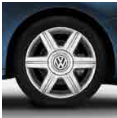
Volkswagen Original Легкосплавный диск Contur Размер диска: 7 J x 16", вылет 50 Используемый размер шин: например, 205/55 R16 Цвет: серебристый Brillant Арт. 1T0 071 496 666
