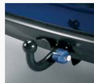
Тягово-сцепное устройство, съёмное, арт. E61002B002
