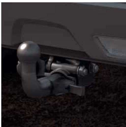
Съемное тягово-сцепное устройство (48) установленное/снятое. При снятом устройстве не забывайте надевать колпачок на стационарную часть, чтобы предотвратить попадание пыли и грязи в отверстие.
