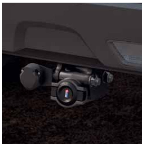
Съемное тягово-сцепное устройство (48) установленное/снятое. При снятом устройстве не забывайте надевать колпачок на стационарную часть, чтобы предотвратить попадание пыли и грязи в отверстие.
