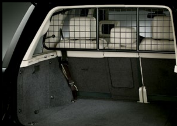
Перегорodka для багажного отделения в половину высоты салона LR007320 Легко снимается. Крепление груза соответствует европейским нормативам.
