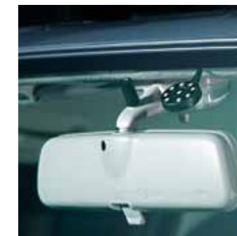
3.18 Датчик дождя Автоматически включает дворники лобового стекла, подбирает оптимальный режим и интервал их работы 990E0-65J81-000
