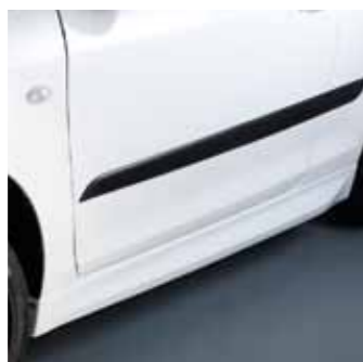
1.2 Боковые накладки порогов 1,2,3 Набор из двух экземпляров, покрытых грунтом. Рекомендуем этот набор аксессуаров окрасить в цвет кузова 990E0-68L03-000
